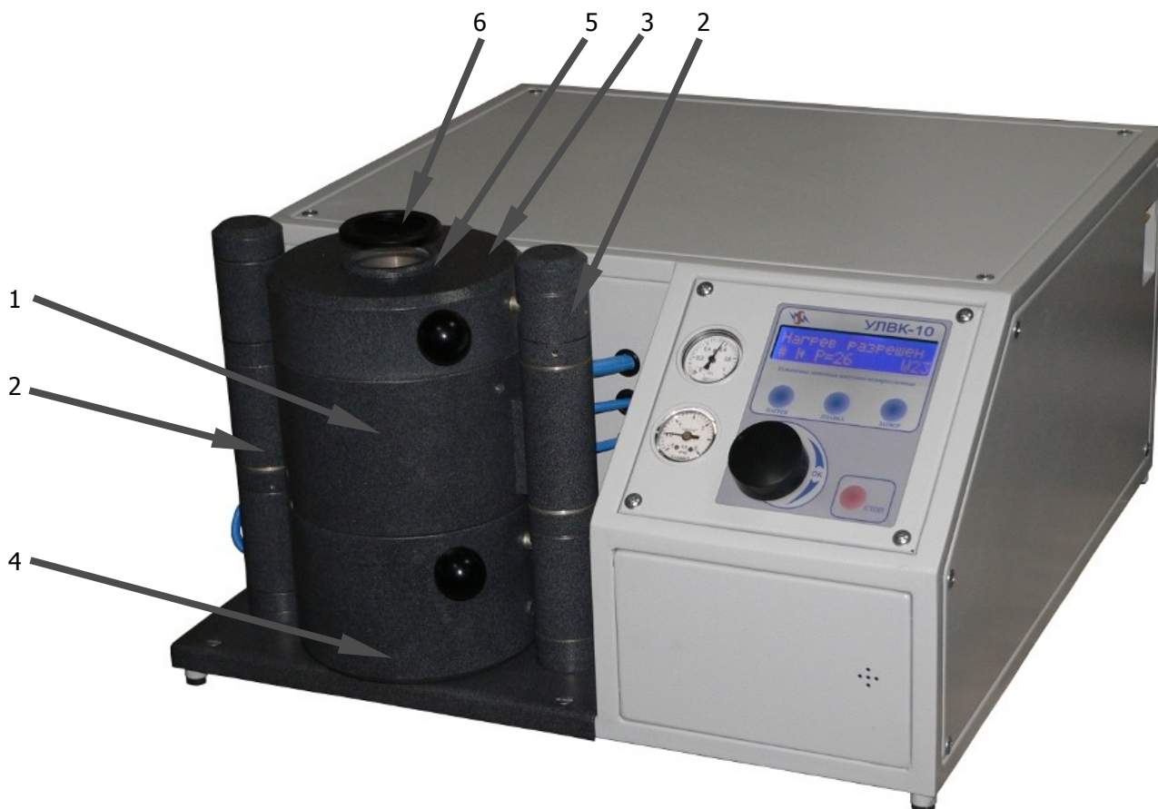
Рисунок 1. 1 - камера индуктора; 2 - стойки; 3 - крышка камеры индуктора; 4 – камера опоки; 5 - смотровое окно; 6 — светофильтр.
