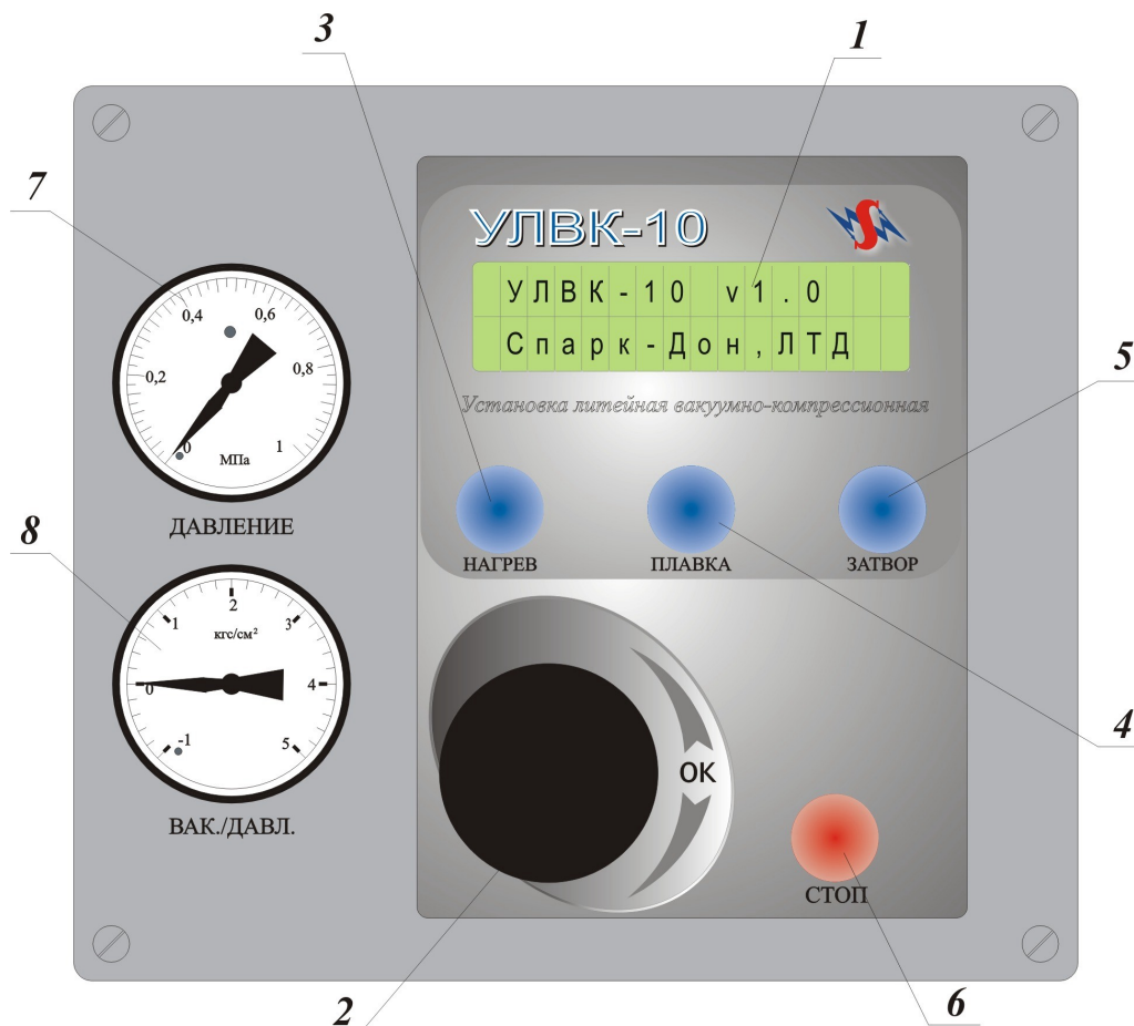
Рисунок 2. 1-Алфавитно-цифровой дисплей; 2 - Задатчик; 3 – Кнопка "НАГРЕВ"; 4 - Кнопка "ПЛАВКА"; 5 - Кнопка "ЗАТВОР"; 6 - Кнопка "СТОП"; 7 - Манометр –указатель рабочего давления; 8-Мановакууметр - указатель давления в камере
