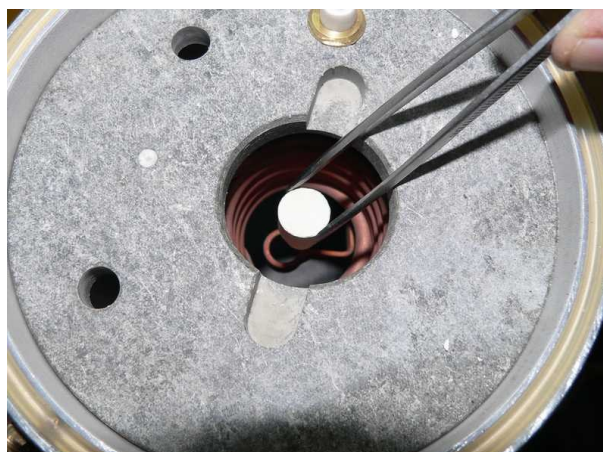
Рисунок 4. Установка керамической вставки в затвор.
