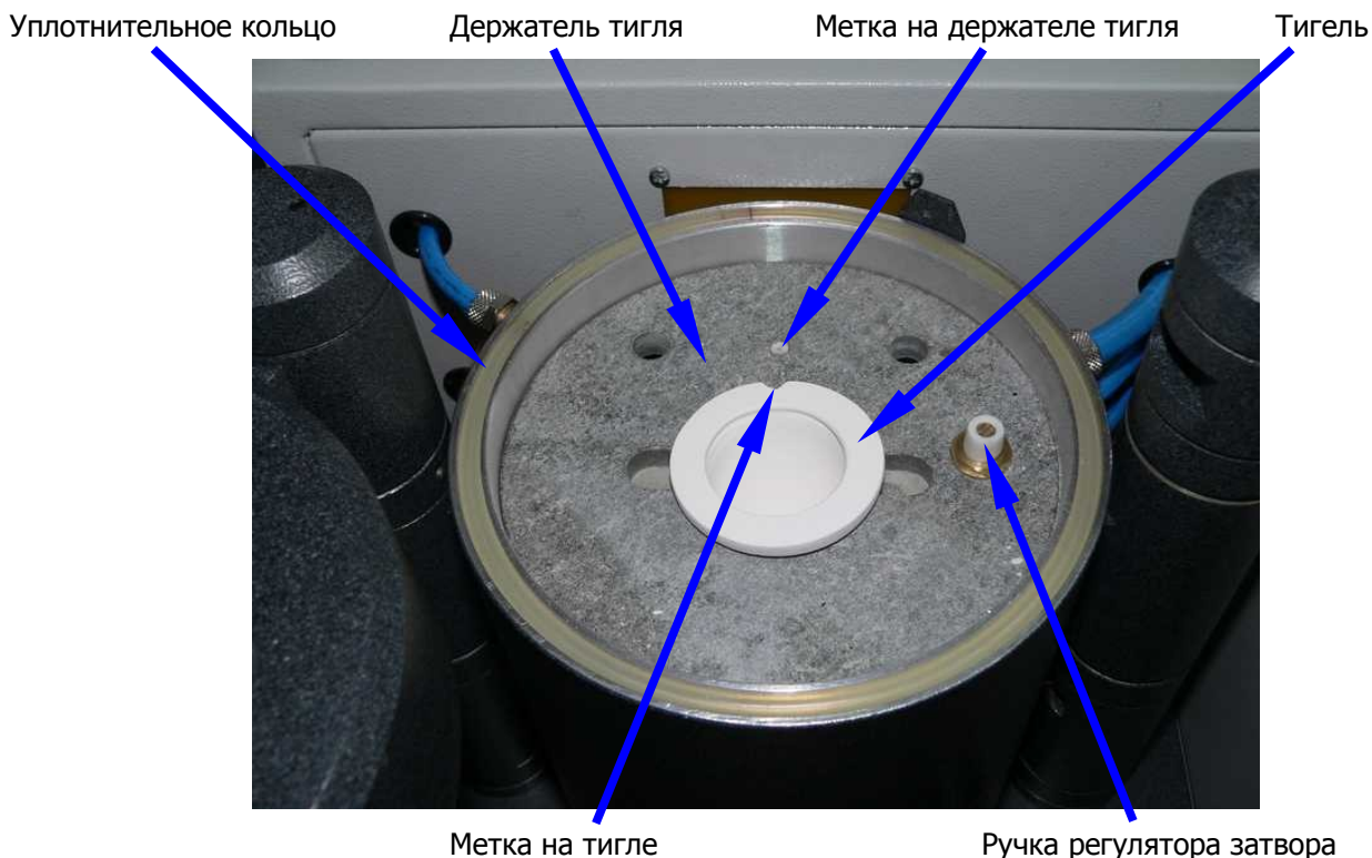
Рисунок 5. Размещение тигля в камере индуктора.
