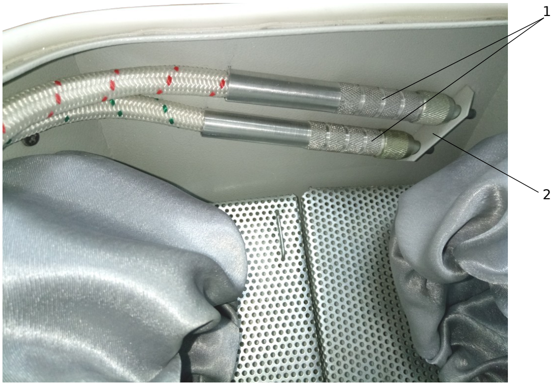
Рисунок 3. Вид на переднюю стенку рабочей камеры: расположение струйных грифелей.
