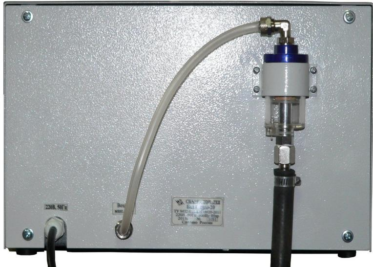
Рисунок 3. Подключение аппарата к источнику сжатого воздуха
