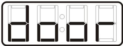
в данном примере на дисплее отображено, что у аппарата открыта дверь при пуске цикла прессования.
