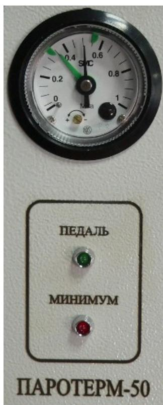
Рисунок 2. Лицевая панель аппарата
