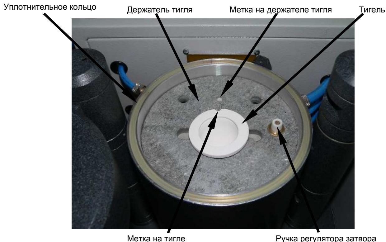
8.6 Рисунок 5. Размещение тигля в камере индуктора.
