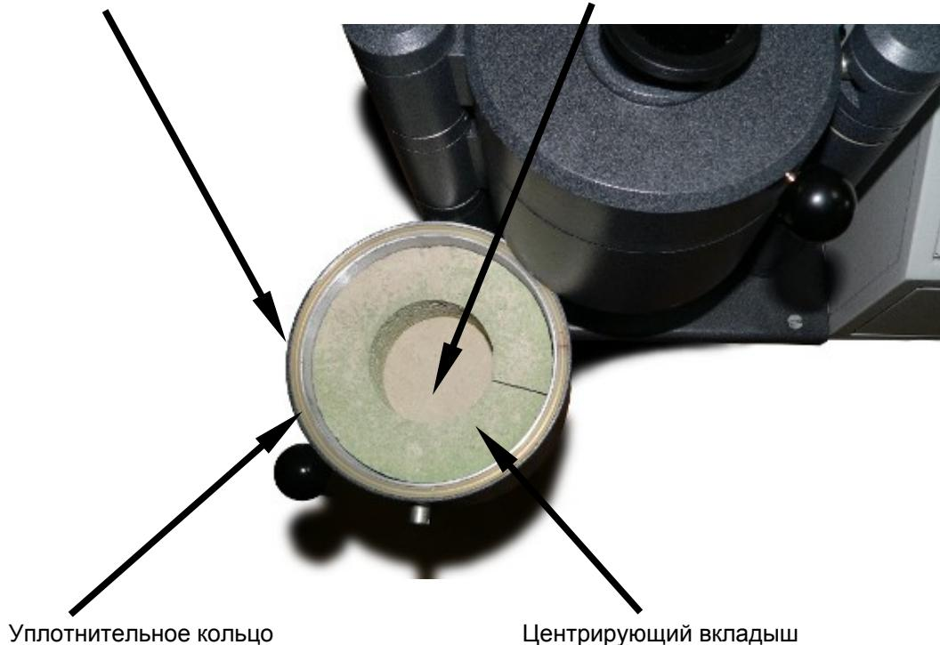
Рисунок 3. Камера опоки (в открытом состоянии).
