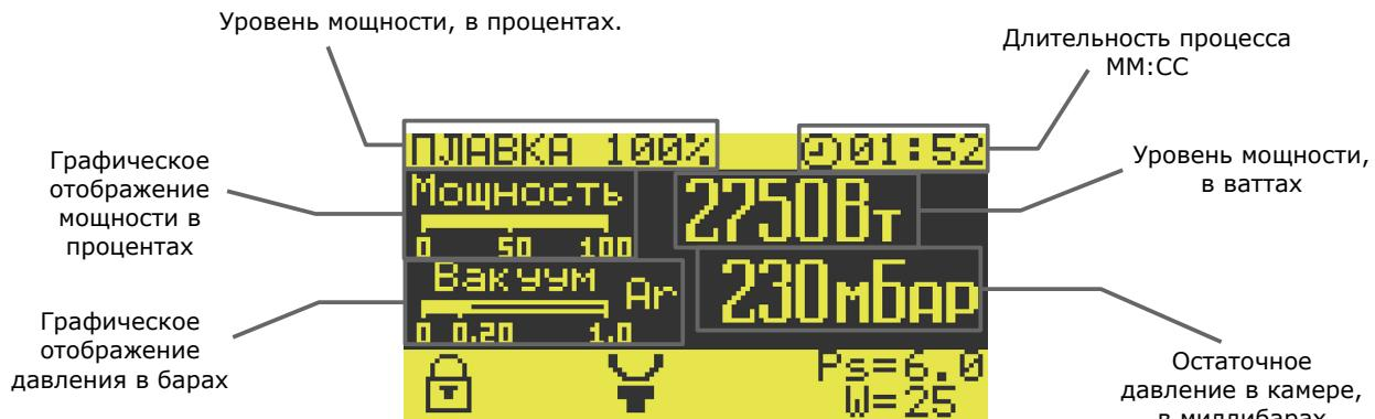
В процессе плавки металла, вращая задатчик, можно оперативно регулировать мощность.
