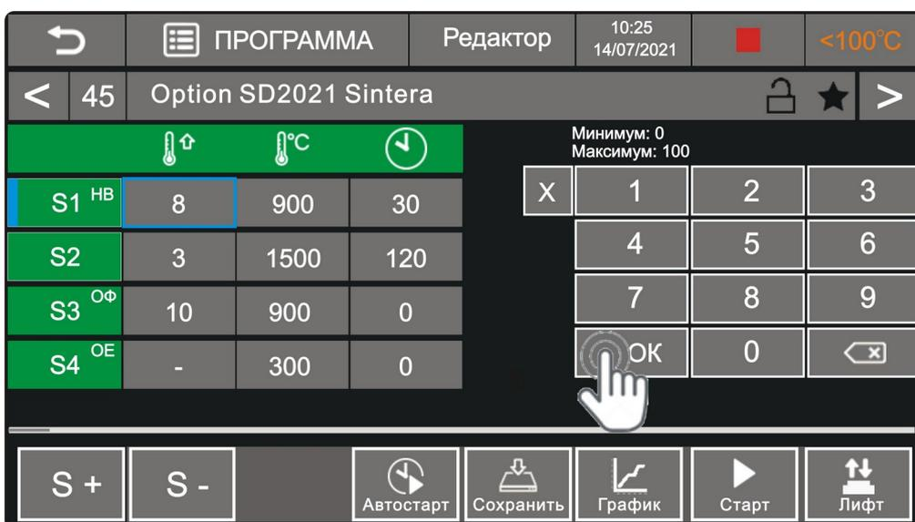
Рис.15 Подтверждение ввода значения скорости  $V=8^{\circ}\text{C}/\text{мин}$ .
