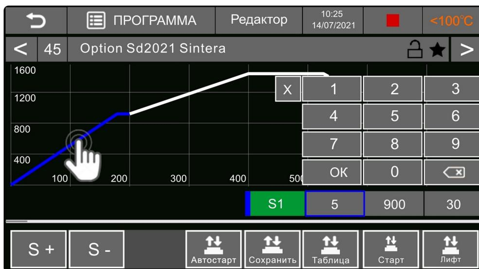
Рис. 17 Редактирование программы в режиме «График».
