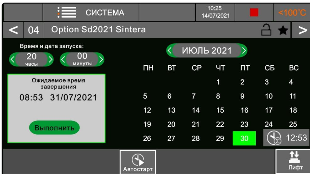
Рис. 24 Экран задания временных параметров функции «АВТОСТАРТ».
