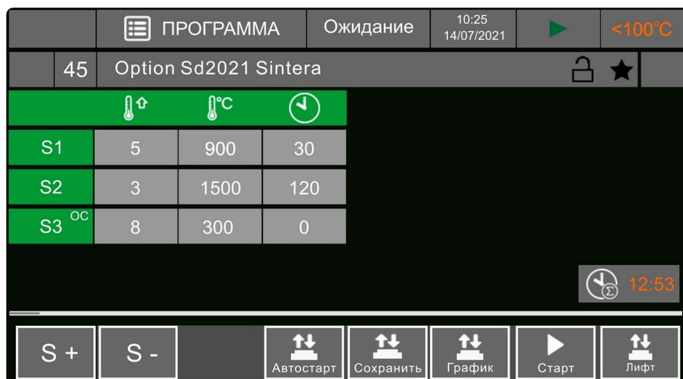
Рис.30 Экран с выбранной программой термообработки.
