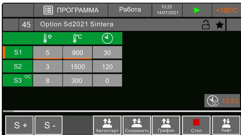
Рис. 31 Экран печи в процессе выполнения программы термообработки.
