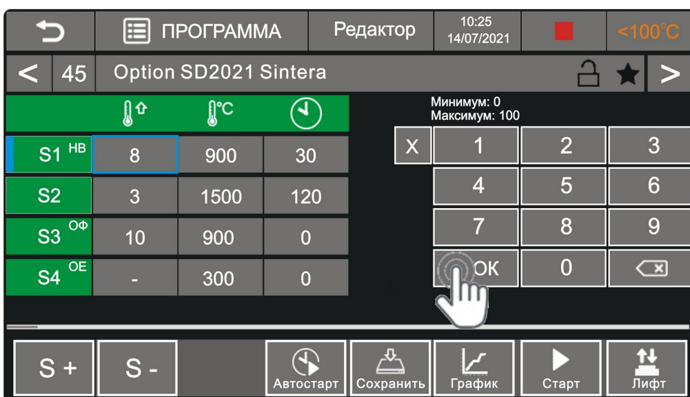
Рис.15 Подтверждение ввода значения скорости V=8^{\circ}\text{C}/\text{мин} .
