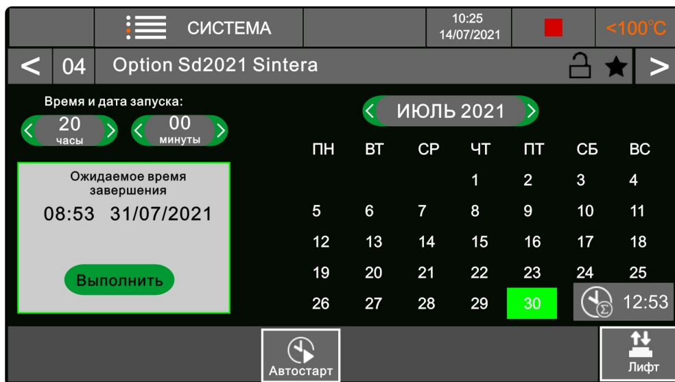
Рис. 24 Экран задания временных параметров функции «АВТОСТАРТ».
