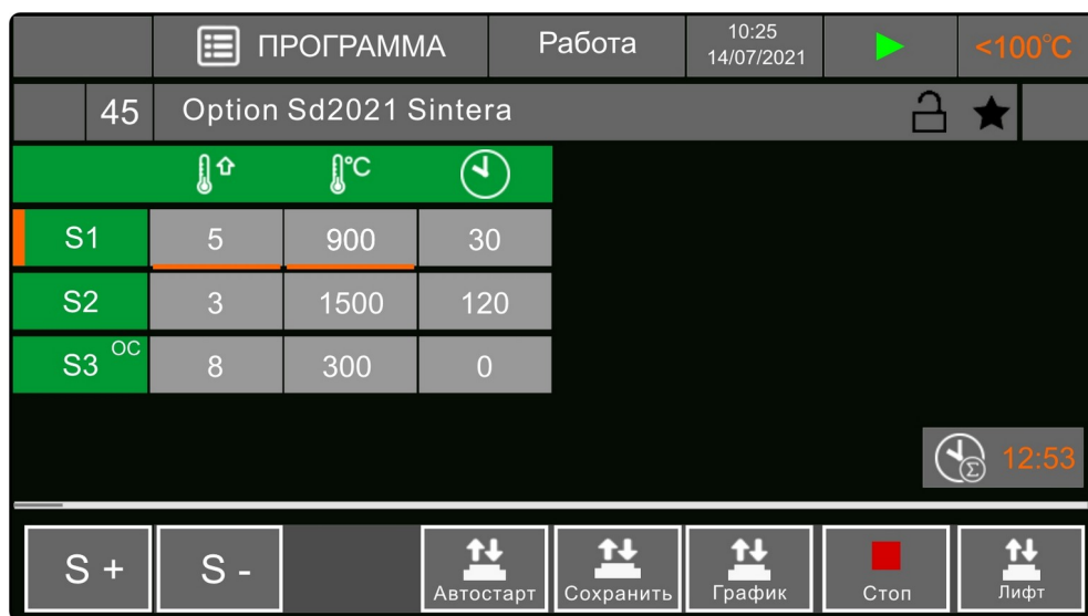
Рис. 31 Экран печи в процессе выполнения программы термообработки.
