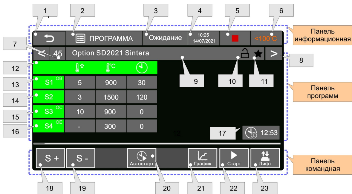
Рис. 8 Экран электропечи в режиме «ПРОГРАММА - Ожидание». Табличная форма. На данном экране представлены следующие элементы графического интерфейса:
