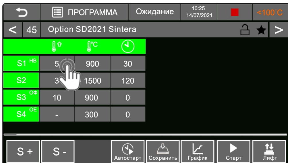
Рис. 10 Программа термообработки «Option SD2021 Sintera».
