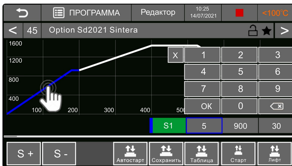
Рис. 17 Редактирование программы в режиме «График».
